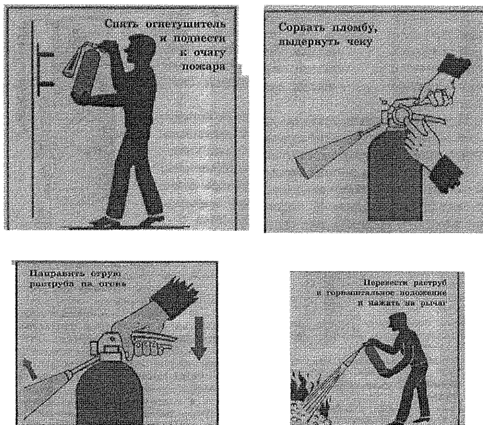
Рис. 8. Приведение в действие ручного углекислотного огнетушителя
